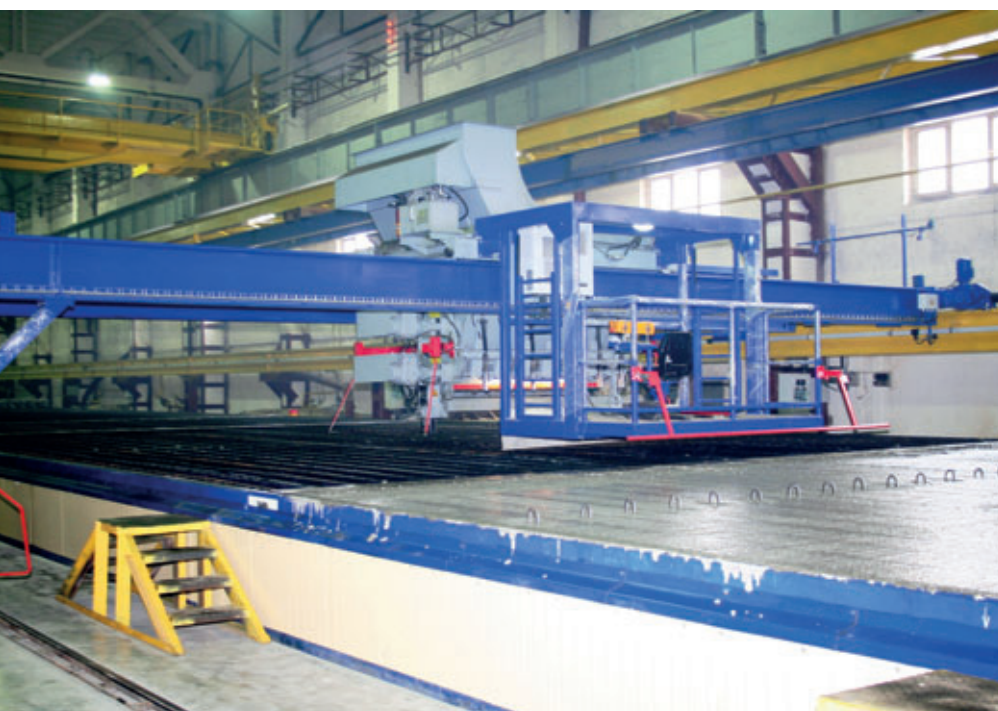
Produção de estacas cravadas na TDSK Tomsk
