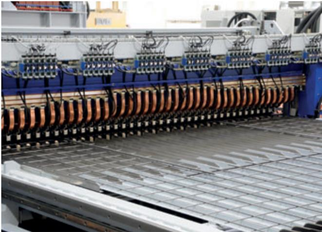
Instalação de soldagem de malhas FBE/158 da EVG
