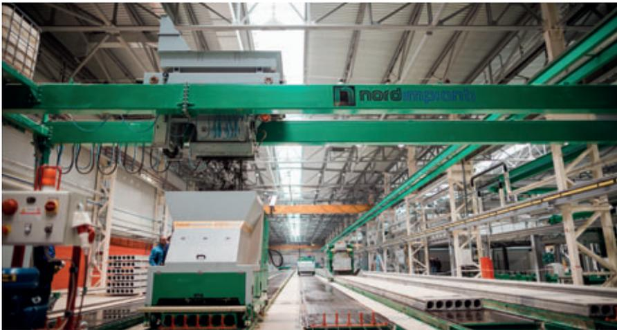
Instalação de produção de lajes alveolares protendidas da Nordimpianti
