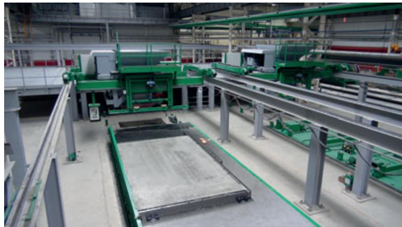
Distribuidor de concreto com estação de adensamento
