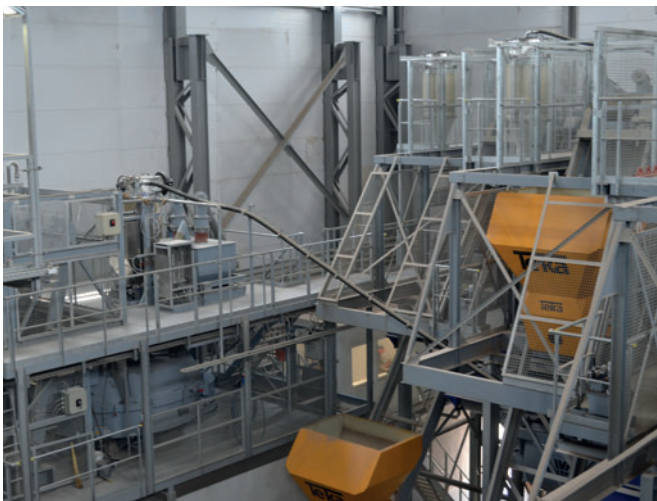
Die gesamte Betonmischanlage setzt sich zusammen aus fünf nebeneinander stehenden und komplett eigenständigen und unabhängigen Mischstationen.
