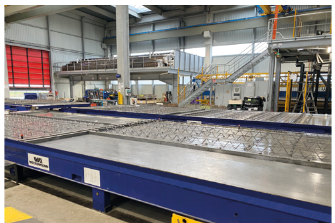
Palettes de Weckenmann (60 palettes livrées, dont 12 avec coffrage de rive de 60 mm de haut et 48 avec coffrage de rive de 70 mm de haut) Mise en place des armatures et des palettes avec coffrage en A et aimants intégrés
