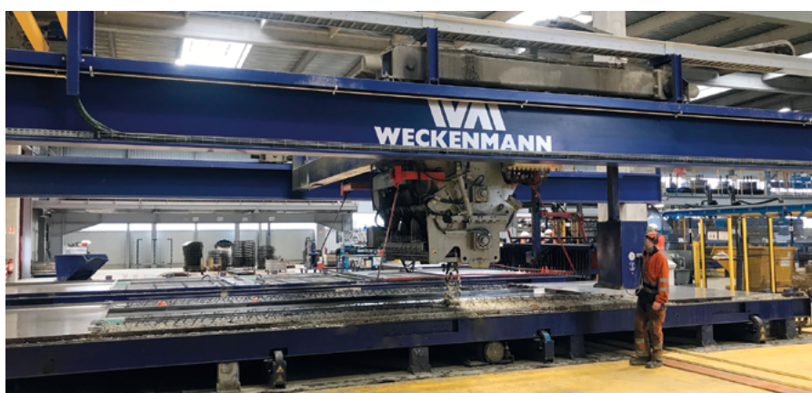
Distributeur de béton
