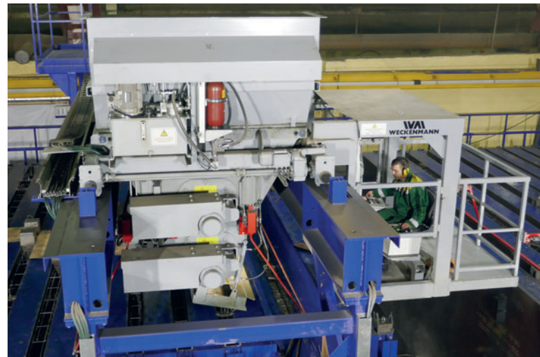
Distribuidor de hormigón tipo semipórtico durante el hormigonado
