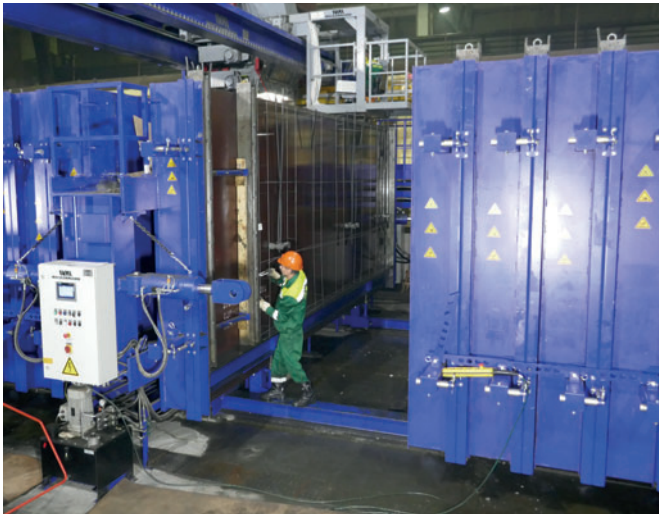
Preparación de la futura placa de muro
