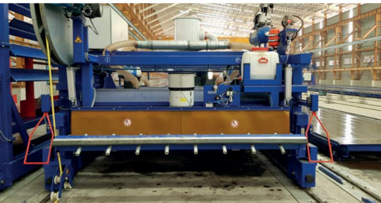
*Instalação de limpeza e pulverização para agente de liberação com barra de tração para cabos tensores*
