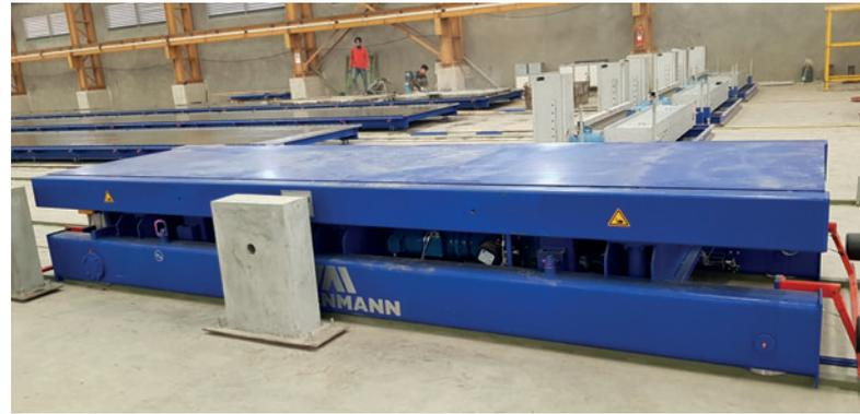
*Carro de extração com plataforma elevatória hidráulica para recolha das pilhas de lajes*
