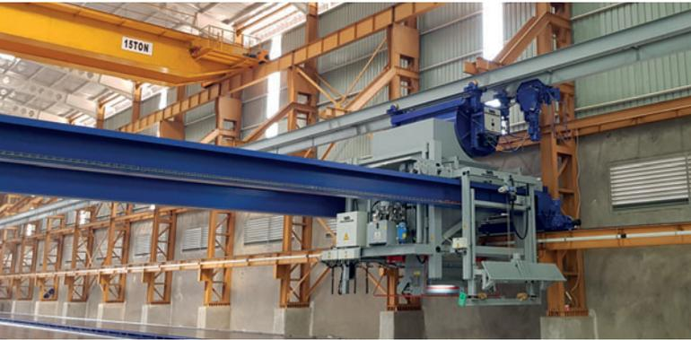
*Distribuidor de concreto de semipórtico com caçamba transportadora durante a recolha de concreto*
