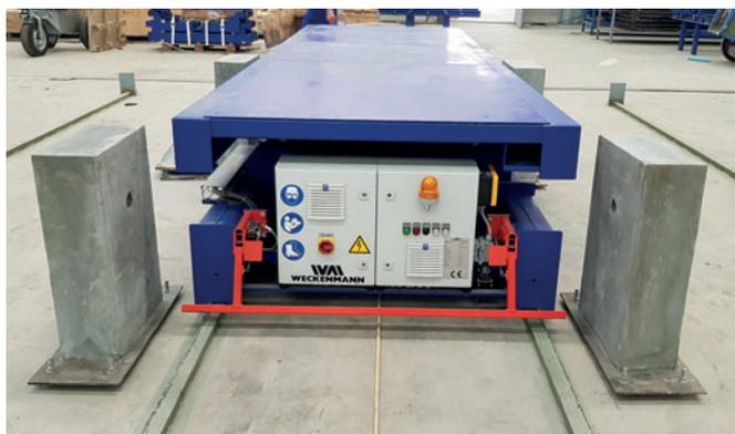
*Carro de extração com plataforma elevatória hidráulica para recolha das pilhas de lajes*
