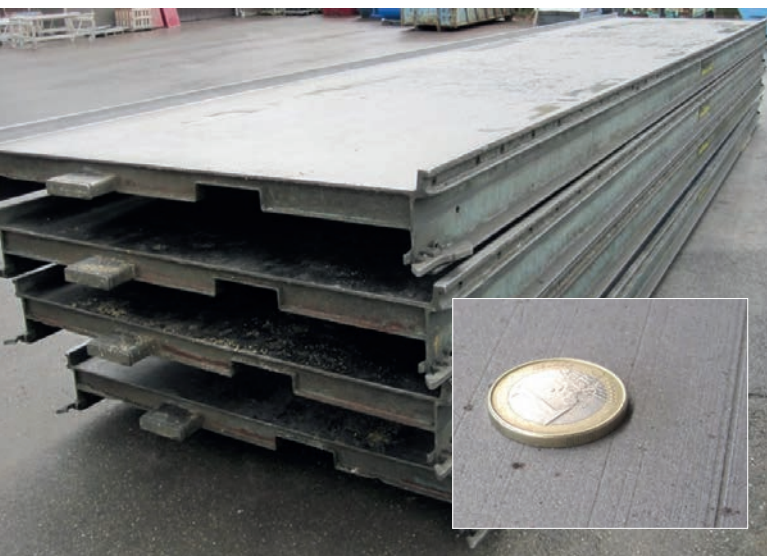
翻新前，托盘模板表面质量不佳：深度划痕、模板表面不光滑、喷漆质量差
