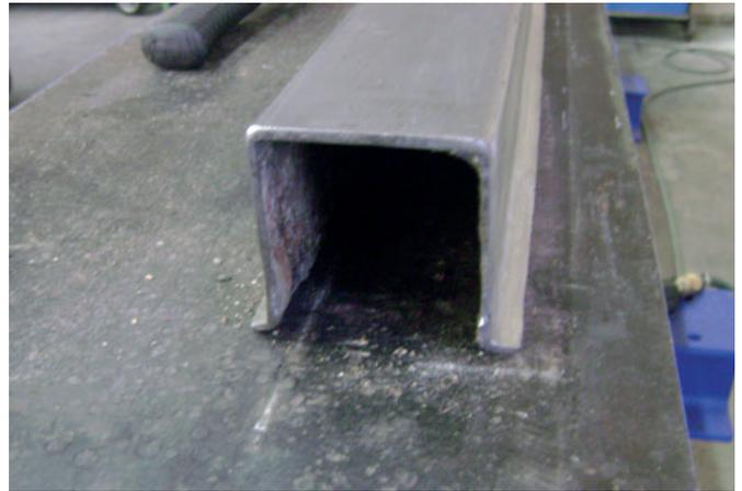
Después: Encofrados como nuevos: encofrados rectos enderezados y con función optimizada
