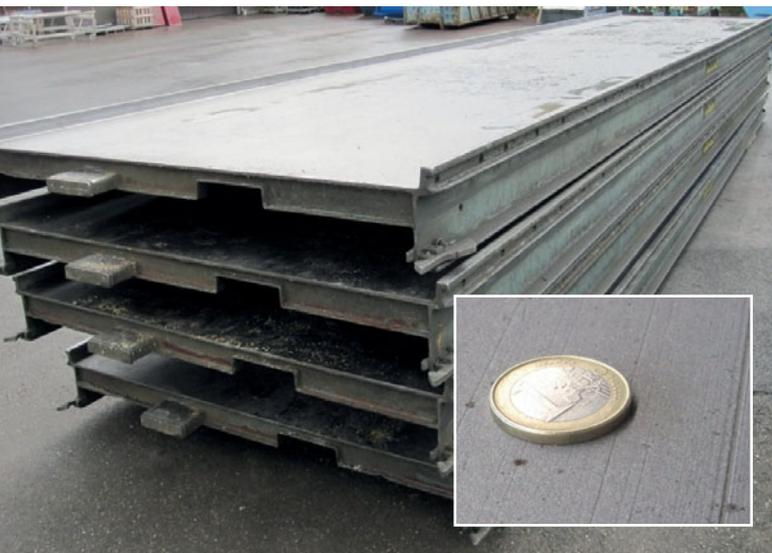
*Superficie de encofrado de bandeja con mala calidad antes del reacondicionamiento: profundas estrías y superficie de encofrado irregular; pintura defectuosa*
