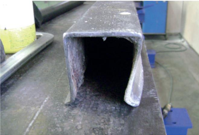
Antes del reacondicionamiento de los sistemas de encofrado: encofrados deformados y abollados
