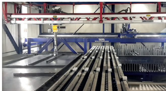
Из магазина опалубочные профили поступают на опалубочный робот по новым рольгангам
