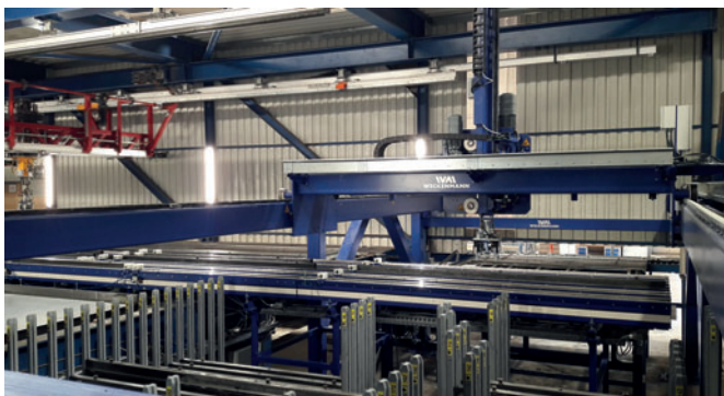
Новый накопитель Weckenmann с расширенным магазином и новыми тактовыми рольгангами
