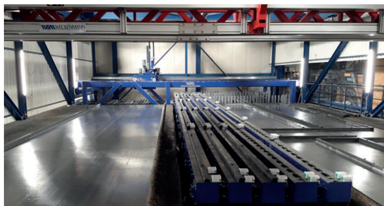
*Tras la modernización: Instalación de encofrado con nuevas vías de rodillos de ciclo y nuevo almacenador Weckenmann*
