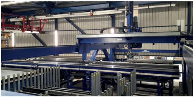
El nuevo almacenador Weckenmann con un depósito ampliado y las nuevas vías de rodillos de ciclo
