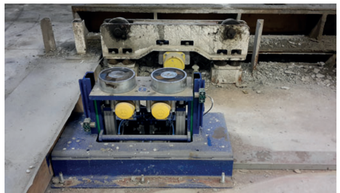
MagVib - Unité de compactage haute fréquence (en bleu), avec en arrière-plan le chevalet vibrant utilisé jusqu'ici.
