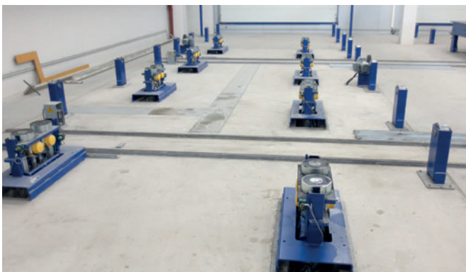
Vibreurs haute fréquence équipés d'aimants sur une station de compactage MagVib.
