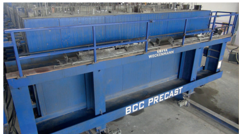
Uno de los dos encofrados en batería para los muros interiores y exteriores.
