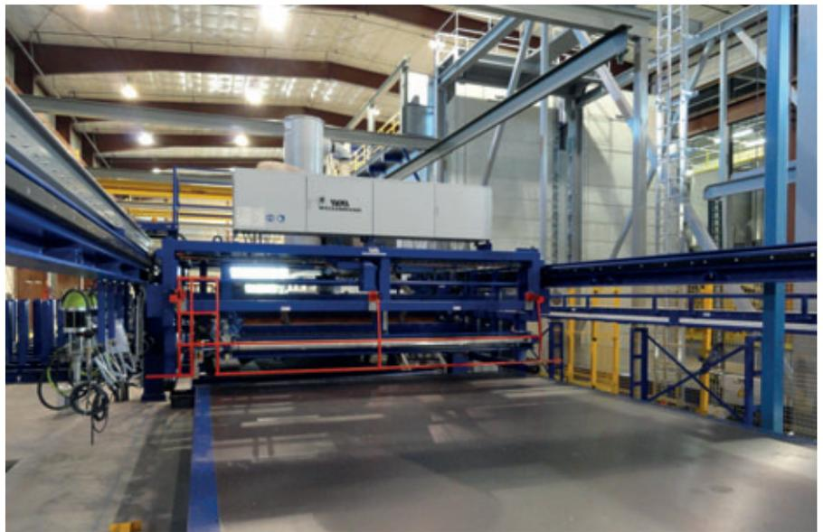
Sur la station CPO (Cleaning, Plotting, Oiling = nettoyage, traçage, huilage), les dimensions des panneaux et les positions des éléments incorporés sont téléchargées sur le traceur automatique à partir d'un fichier CAO et transposées directement sur la palette propre.
